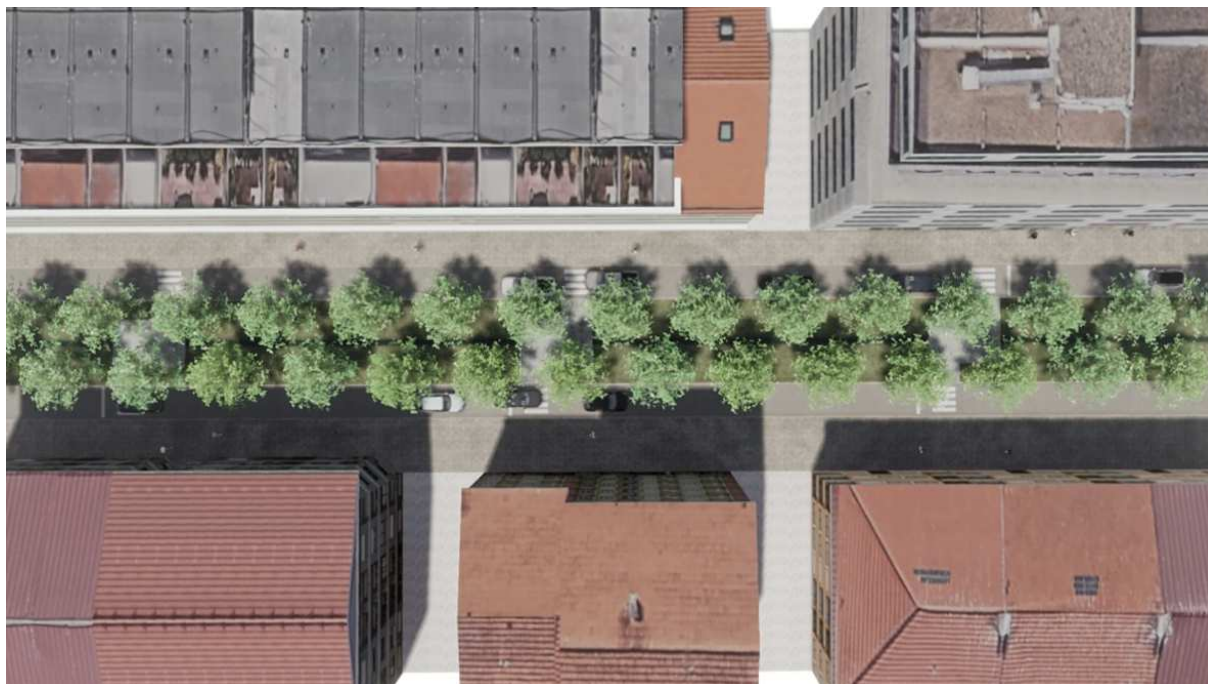
Figura 5.25 – Exemplo de aplicação do modelo 7 numa rua com 22,10m, com alinhamento central duplo de árvores de copa média-larga, do tipo cerejeira-brava ( Prunus avium ), amieiro ( Alnus glutinosa ) ou bétula ( Betula pubescens ssp. celtica ): vista de topo (visualização realista).
