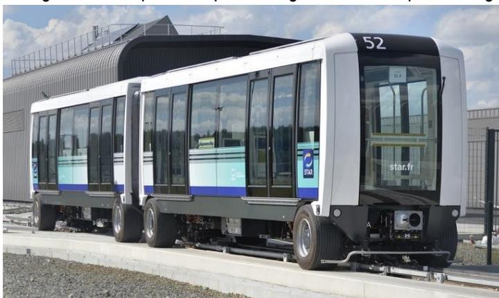
Figura 114 – Modelo Cityval/ Airval da marca Siemens
