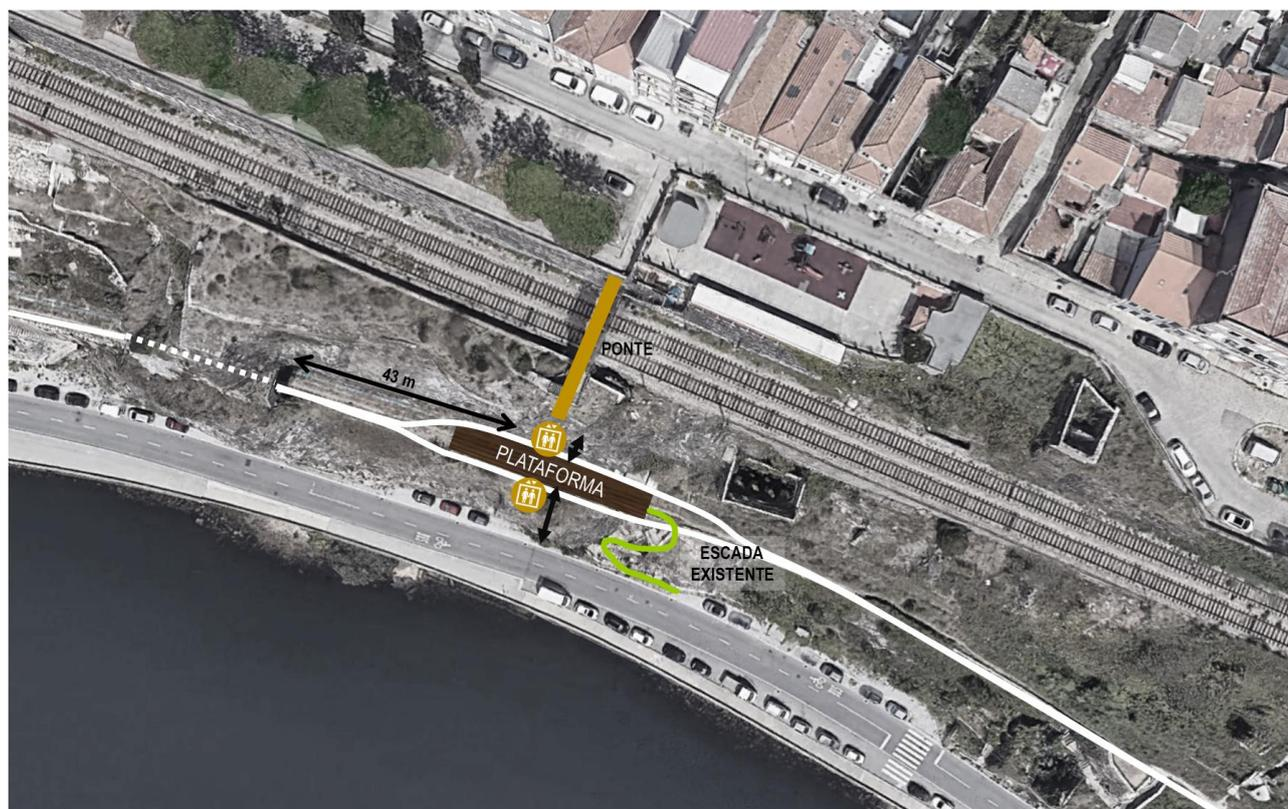
**Figura 17 – Esquema funcional da estação das Fontainhas – Alternativa B (planimetria)**
