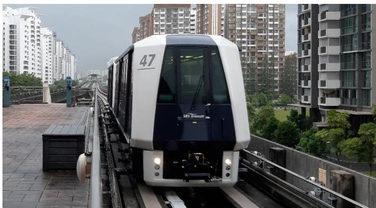
Figura 110 - Modelo Heavy Industries Crystal Mover C810A da marca Mitsubishi
