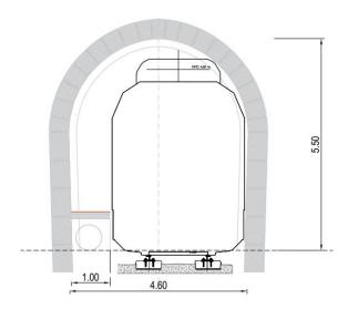
Figura 4 – Perfil tipo com implantação do *Gabarit* livre de obstáculos (GLO) (CPb+) de acordo com a IT.CAT.049, com canal de evacuação de 1,00m e rebaixamento de 0,50 m da plataforma
