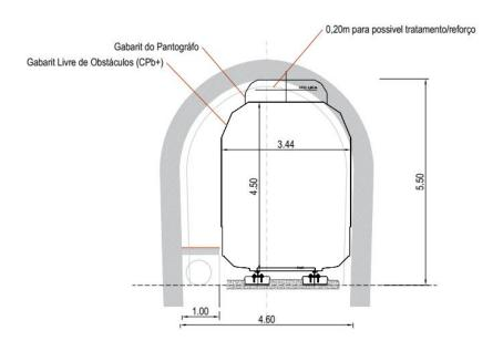
Figura 3 – Perfil tipo com implantação do *Gabarit* livre de obstáculos (GLO) (CPb+) de acordo com a IT.CAT.049, com canal de evacuação de 1.00 m
