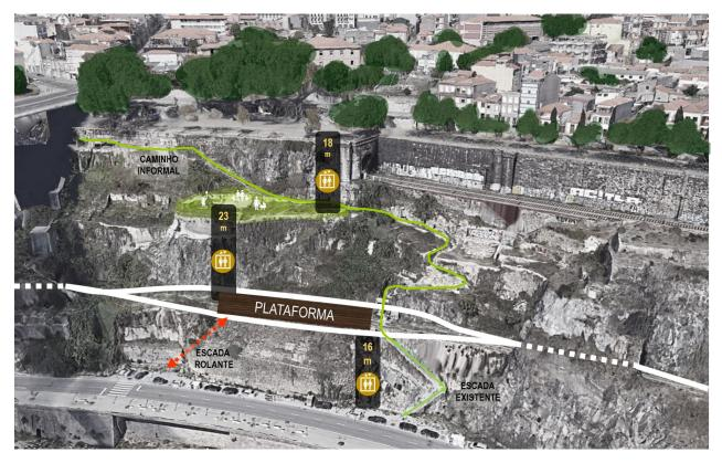
Figura 14 - Esquema funcional da estação das Fontaínhas - Alternativa A (perfil)
