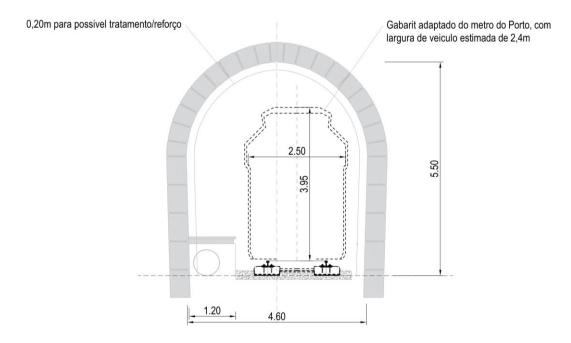
Figura 5 – Perfil tipo com implantação do Gabarit adaptado a partir do veículo do Metro do Porto (Bitola europeia =1,435m), canal de evacuação de 1,20m
