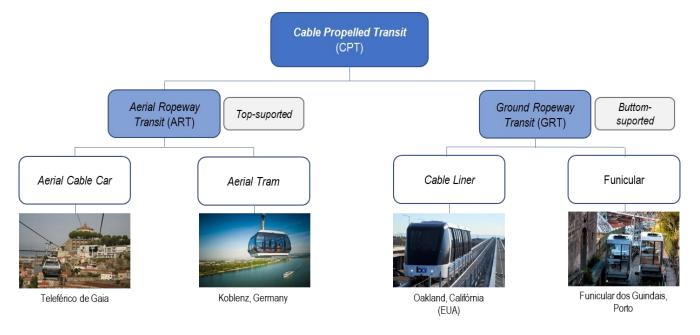
Figura 35 – Classificação dos sistemas CPT (adaptado de Dale & Chu, 2013 e Kremer,2015)
