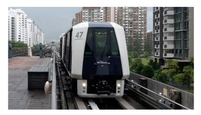
Figura 110 - Modelo Heavy Industries Crystal Mover C810A da marca Mitsubishi
