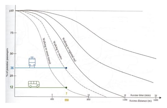
Figura 24 - % de potenciais passageiros em relação à distância a deslocar-se à paragem/estação por modo de transporte (Vuchic,2005)
