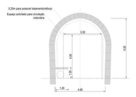
Figura 6 - Perfil tipo com área para implantação do veículo rodoviário, com 1,20m de canal de evacuação
