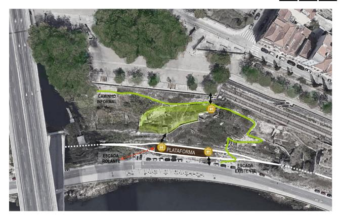
Figura 13 – Esquema funcional da estação das Fontaínhas – Alternativa A (planimetria)
