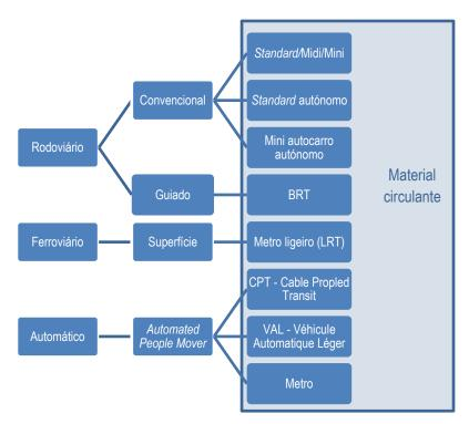
Figura 29 - Sistemas de transporte e material circulante a analisar
