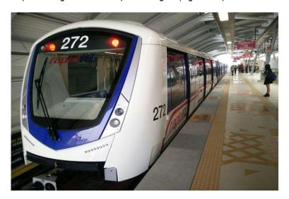
Figura 112 - Modelo Innovia Metro 300 da marca Bombardier Transportation
