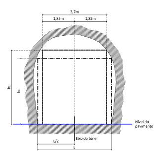
Figura 32 - Esquema de uma secção transversal de um túnel (Metro Mondego)
