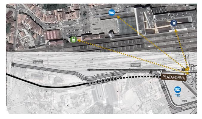
Figura 22 – Esquema funcional da estação de Campanhã – Alternativa B
