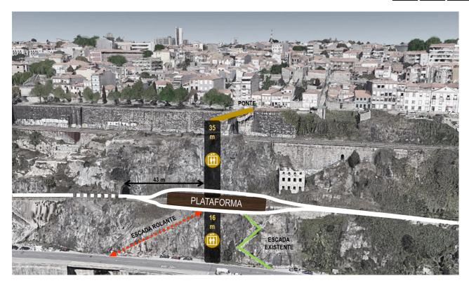
Figura 18 - Esquema funcional da estação das Fontaínhas - Alternativa B (perfil)
