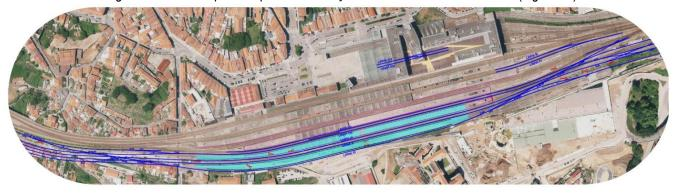
Figura 20 – Inserção das linhas de alta velocidade na estação de Campanhã
