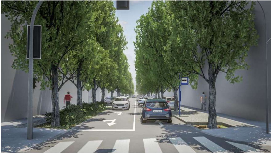
Figura 5.7 - Vista a partir do eixo da rua: espaço viário com duas vias de trânsito (dois sentidos); espaço da arborização com alinhamentos laterais de árvores de copa média-estreita em faixa contínua (com bordadura mista de subarbustos e herbáceas vivazes); espaço pedonal com bandas de pavimento rugoso e liso (circulação universal).
