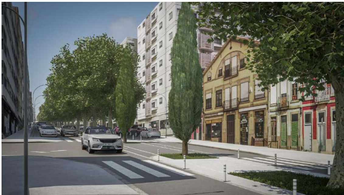
Figura 11.3 - Vista a partir do passeio do lado poente da rua: espaço pedonal com bandas de pavimento rugoso e liso (circulação universal); espaço da arborização com alinhamento central de árvores de copa muito larga, pontuados nos cruzamentos com árvores colunares, perenifólias, em faixa contínua; espaço viário com uma via de trânsito, ciclovia e zona de estacionamento, de cada lado do espaço da arborização.
