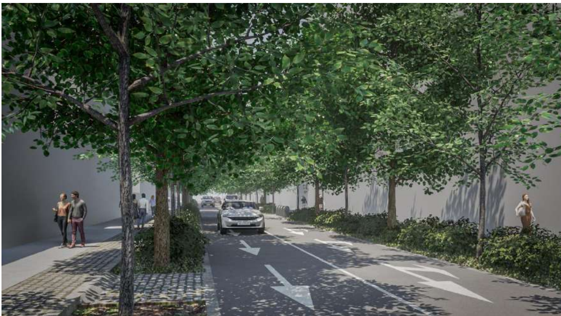
Figura 9.6 - Vista a partir do espaço da arborização do lado poente da rua: espaço da arborização com alinhamentos laterais de árvores de copa média-larga em faixa contínua (com bordadura mista de subarbustos e herbáceas vivazes); espaço viário com duas vias de trânsito (sentido noroeste-sudeste); espaço pedonal com bandas de pavimento rugoso e liso (circulação universal).
