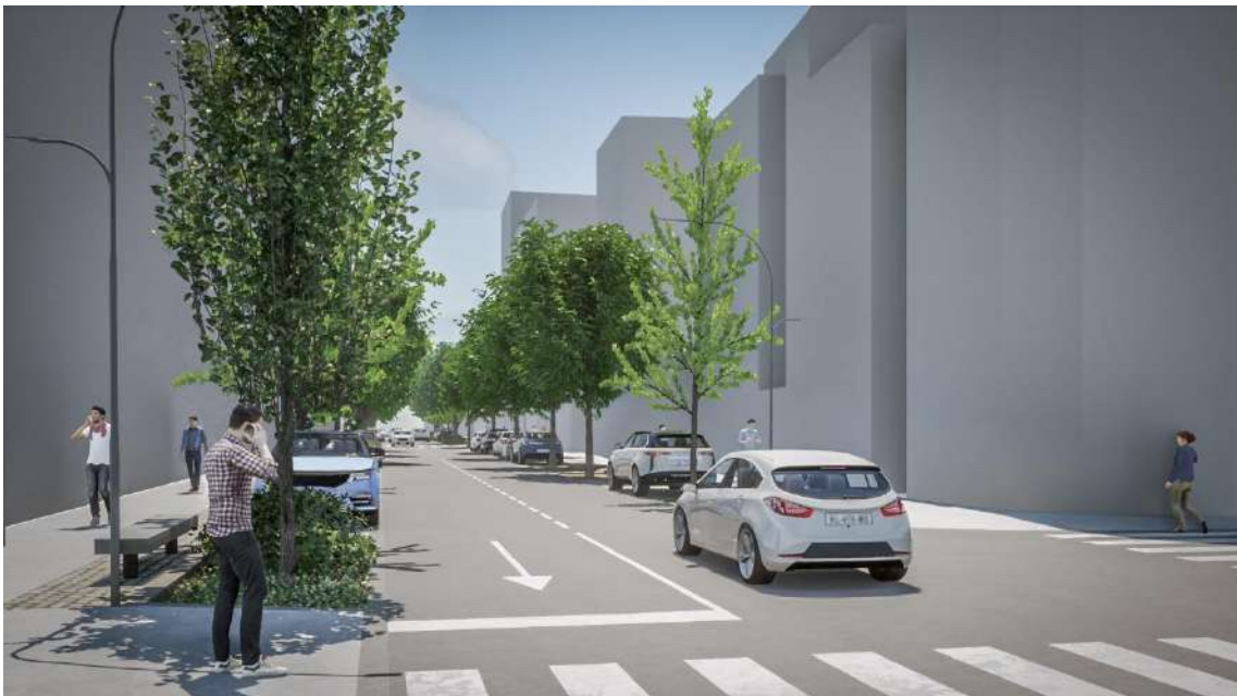
Figura 8.10 - Vista a partir do passeio do lado nascente da rua: espaço pedonal com bandas de pavimento rugoso e liso (circulação universal) e zona de estadia/ de sentar; espaço da arborização com alinhamentos laterais de árvores de copa média-estreita em caldeiras e em faixa contínua (com bordadura mista de subarbustos e herbáceas vivazes); espaço viário com duas vias de trânsito (dois sentidos) e zona de estacionamento que tira partido do espaço da arborização.
