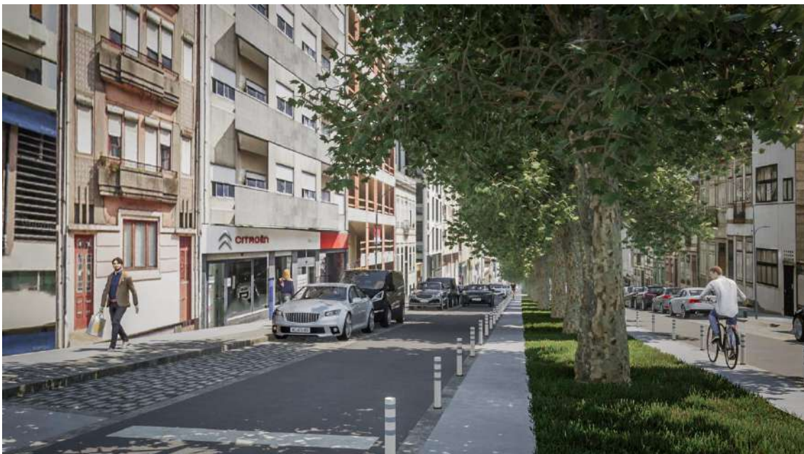
Figura 11.6 - Vista a partir da ciclovia do lado nascente da rua: espaço viário com uma via de trânsito, ciclovia e zona de estacionamento, de cada lado do espaço da arborização; espaço da arborização com alinhamento central de árvores de copa muito larga, em faixa contínua; espaço pedonal com bandas de pavimento rugoso e liso (circulação universal).
