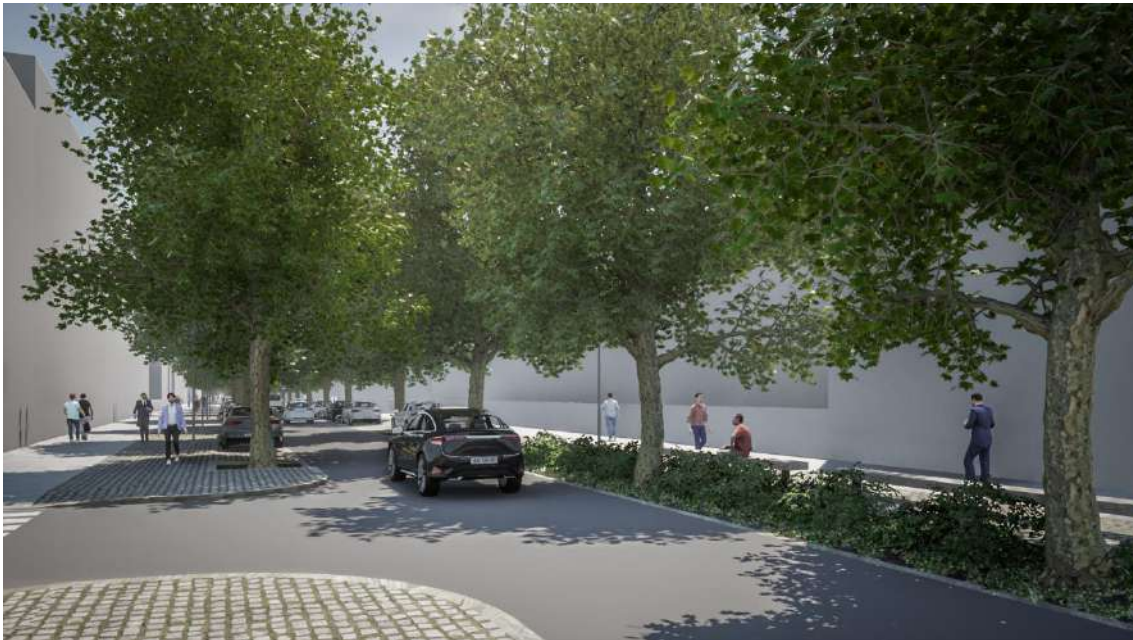
Figura 12.11 - Vista a partir do passeio do lado nascente da rua: espaço pedonal com bandas de pavimento rugoso e liso (circulação universal); espaço da arborização com alinhamentos laterais de árvores de copa muito larga ( Platanus x acerifolia ) em caldeira e em faixa contínua (com bordadura mista de subarbustos e herbáceas vivazes); espaço viário com uma via de trânsito (sentido norte-sul) e zona de estacionamento que tira partido do espaço da arborização.
