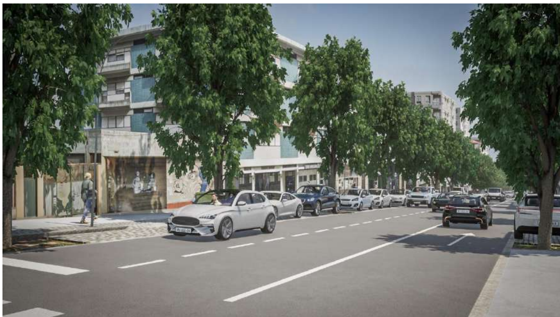
Figura 11.9 - Vista a partir do passeio do lado poente da rua: espaço viário com três vias de trânsito (dois sentidos) e zona de estacionamento que tira partido do espaço da arborização; espaço da arborização com alinhamentos laterais de árvores de copa média-larga em caldeira; e espaço pedonal com bandas de pavimento rugoso e liso (circulação universal).
