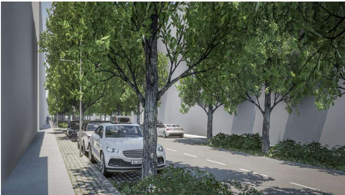
Figura 5.4 - Vista a partir do passeio do lado nascente da rua: espaço pedonal com bandas de pavimento rugoso e liso (circulação universal); espaço da arborização com alinhamentos laterais de árvores de copa média-estreita em faixa contínua (com bordadura mista de subarbustos e herbáceas vivazes); espaço viário com duas vias de trânsito (dois sentidos).
