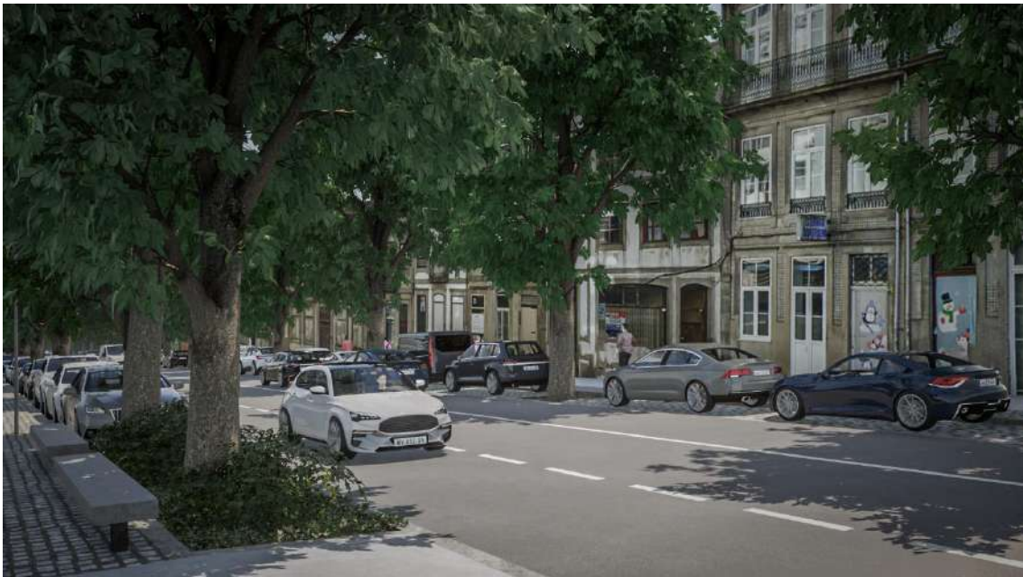
Figura 11.11 - Vista a partir do passeio do lado nascente da rua: espaço pedonal com bandas de pavimento rugoso e liso (circulação universal) e zona de estadia/ de sentar; espaço da arborização com alinhamentos laterais de árvores de copa média-larga em caldeira e em faixa contínua (com bordadura mista de subarbustos e herbáceas vivazes); espaço viário com três vias de trânsito (dois sentidos) e zona de estacionamento que tira partido do espaço da arborização.
