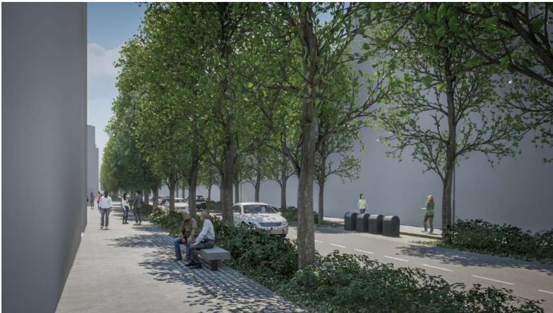
Figura 8.5 - Vista a partir do passeio do lado nascente da rua: espaço pedonal com bandas de pavimento rugoso e liso (circulação universal) e zona de estadia/ de sentar; espaço da arborização com alinhamentos laterais de árvores de copa média-estreita em faixa contínua (com bordadura mista de subarbustos e herbáceas vivazes); espaço viário com duas vias de trânsito (dois sentidos).
