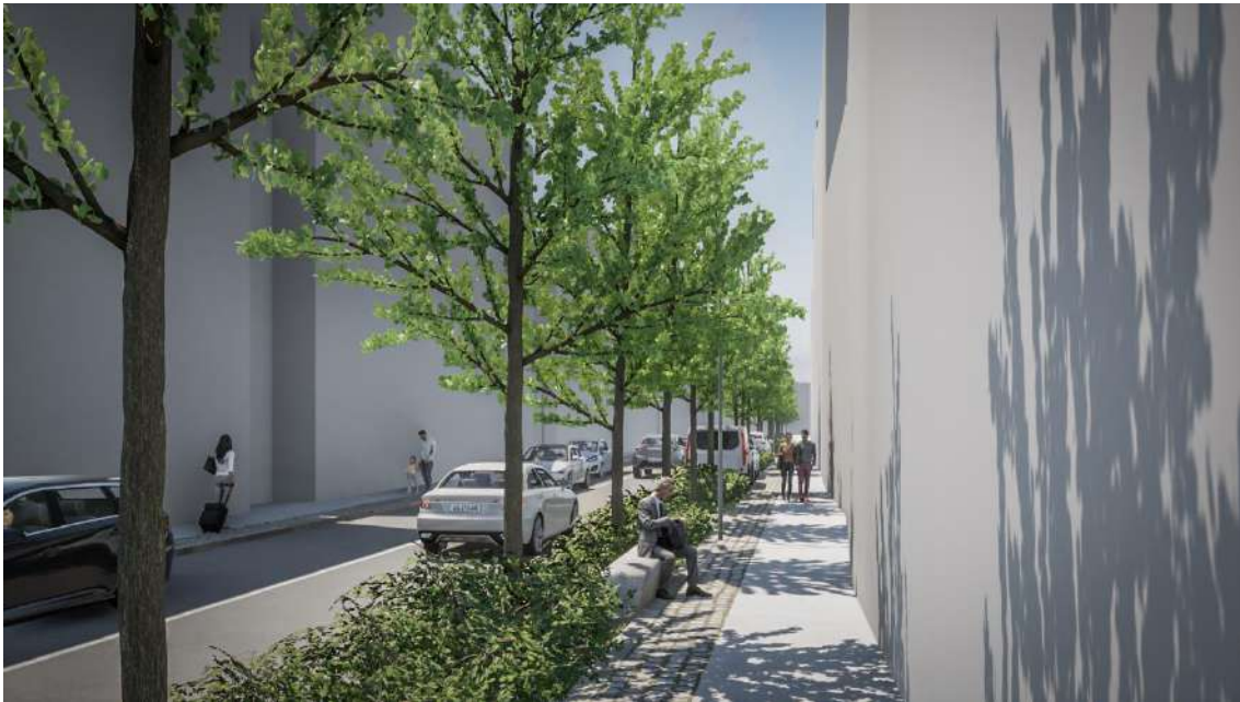
Figura 4.5 - Vista a partir do passeio do lado norte da rua: espaço pedonal com bandas de pavimento rugoso e liso (circulação universal) e zona de estadia/ de sentar; espaço da arborização com alinhamento lateral de árvores de copa estreita em faixa contínua (com bordadura mista de subarbustos e herbáceas vivazes); espaço viário com duas vias de trânsito (dois sentidos).
