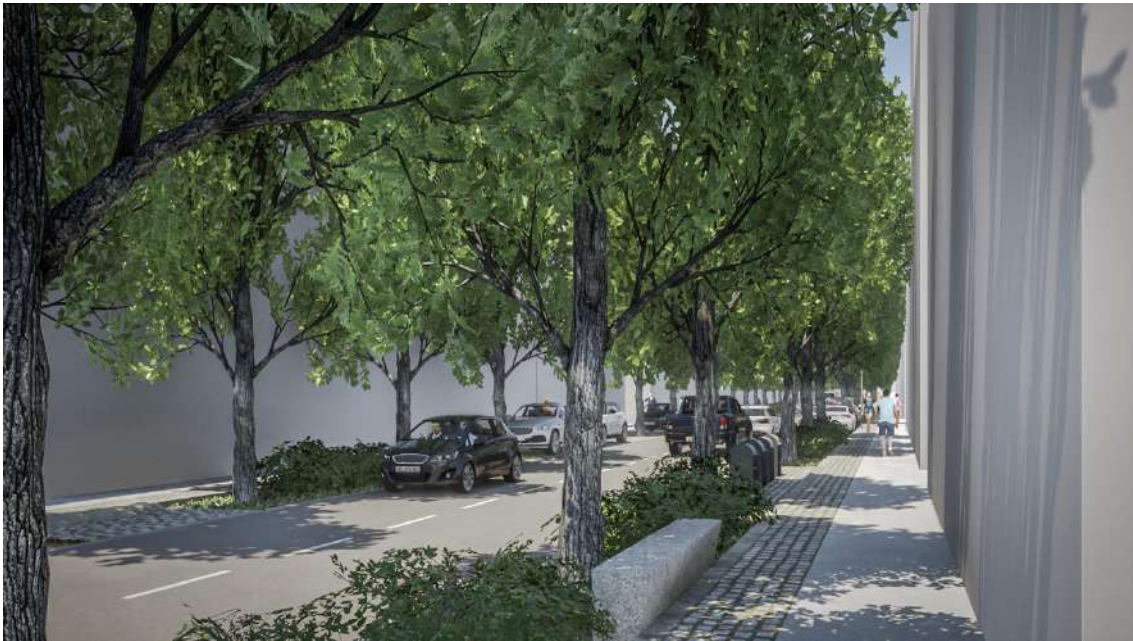
Figura 5.5 - Vista a partir do passeio do lado poente da rua: espaço pedonal com bandas de pavimento rugoso e liso (circulação universal) e zona de estadia/de sentar; espaço da arborização com alinhamentos laterais de árvores de copa média-estreita em faixa contínua (com bordadura mista de subarbustos e herbáceas vivazes); espaço viário com duas vias de trânsito (dois sentidos).
