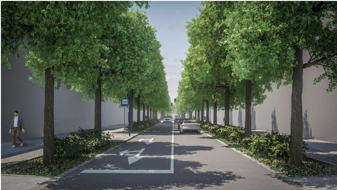
Figura 10.8 - Vista a partir do eixo da rua: espaço viário com duas vias de trânsito (dois sentidos); espaço da arborização com alinhamentos laterais de árvores de copa média-larga em faixa contínua (com bordadura mista de subarbustos e herbáceas vivazes); espaço pedonal com bandas de pavimento rugoso e liso (circulação universal).
