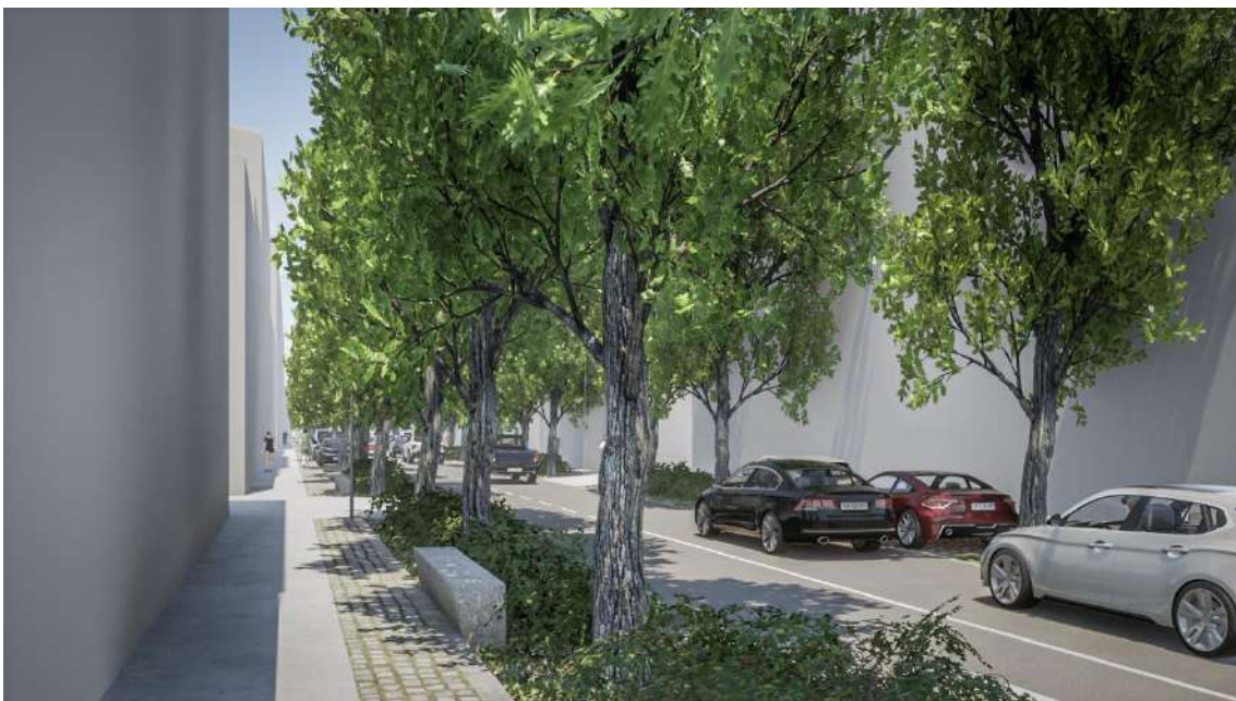
Figura 5.8 - Vista a partir do passeio do lado nascente da rua: espaço pedonal com bandas de pavimento rugoso e liso (circulação universal) e zona de estadia/de sentar; espaço da arborização com alinhamentos laterais de árvores de copa média-estreita em faixa contínua (com bordadura mista de subarbustos e herbáceas vivazes); espaço viário com duas vias de trânsito (dois sentidos) e zona de estacionamento que tira partido do espaço da arborização.
