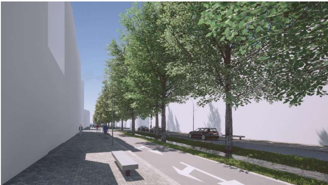
Figura 10.4 - Vista a partir do passeio do lado sul da rua: espaço pedonal com pavimento rugoso e zona de estadia/de sentar; espaço viário com uma via de trânsito, de cada lado do espaço da arborização; espaço da arborização com alinhamento central de árvores de copa muito larga em faixa contínua.
