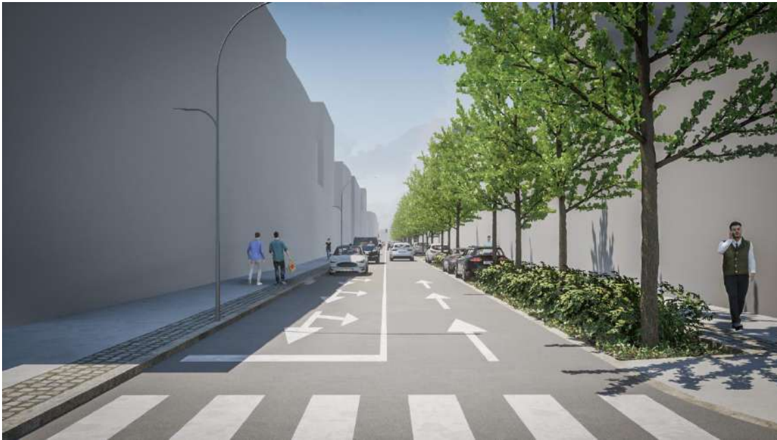
Figura 4.3 - Vista a partir do eixo da rua: espaço viário com duas vias de trânsito (dois sentidos) e zona de estacionamento que tira partido do espaço da arborização; espaço da arborização com alinhamento lateral de árvores de copa estreita em faixa contínua (com bordadura mista de subarbustos e herbáceas vivazes); espaço pedonal com bandas de pavimento rugoso e liso (circulação universal).
